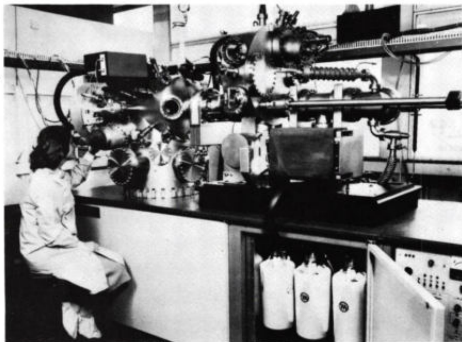
Machine voor molecuulbundel-epitaxie in gebruik bij de Philips Research Laboratoria te Redhill (GB) (foto: Philips).
